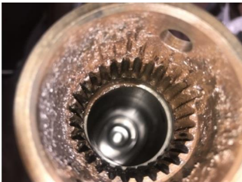
Состояние шлиц втулки шлицевой после испытаний
