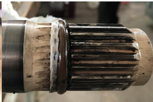
Состояние шлиц втулки шлицевой после испытаний
