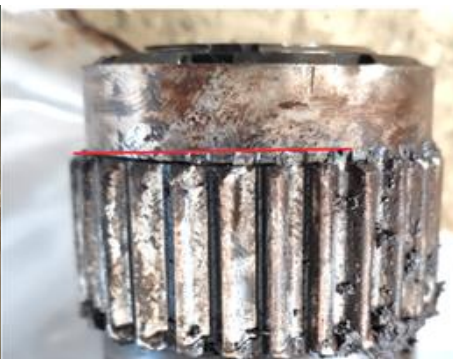
Состояние шлиц валика шлицевого после испытаний
