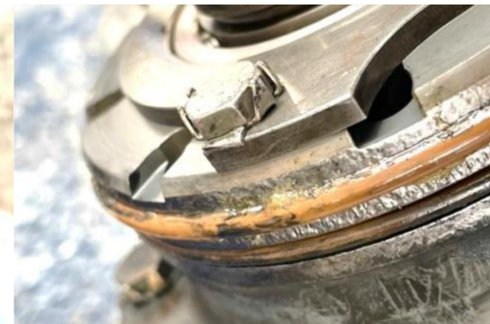
Поврежденные уплотнительные кольца наклеп на посадочном месте УКП
